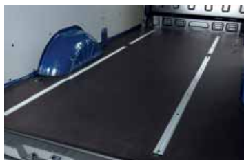
Dvě kolejnice v podlaze pro zajištění nákladu
