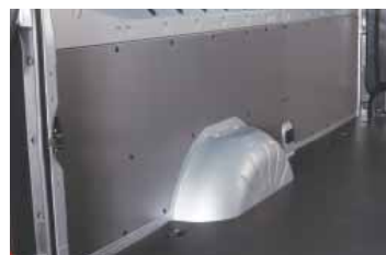
Kryty bočních stěn (dřevoláknitá deska)
